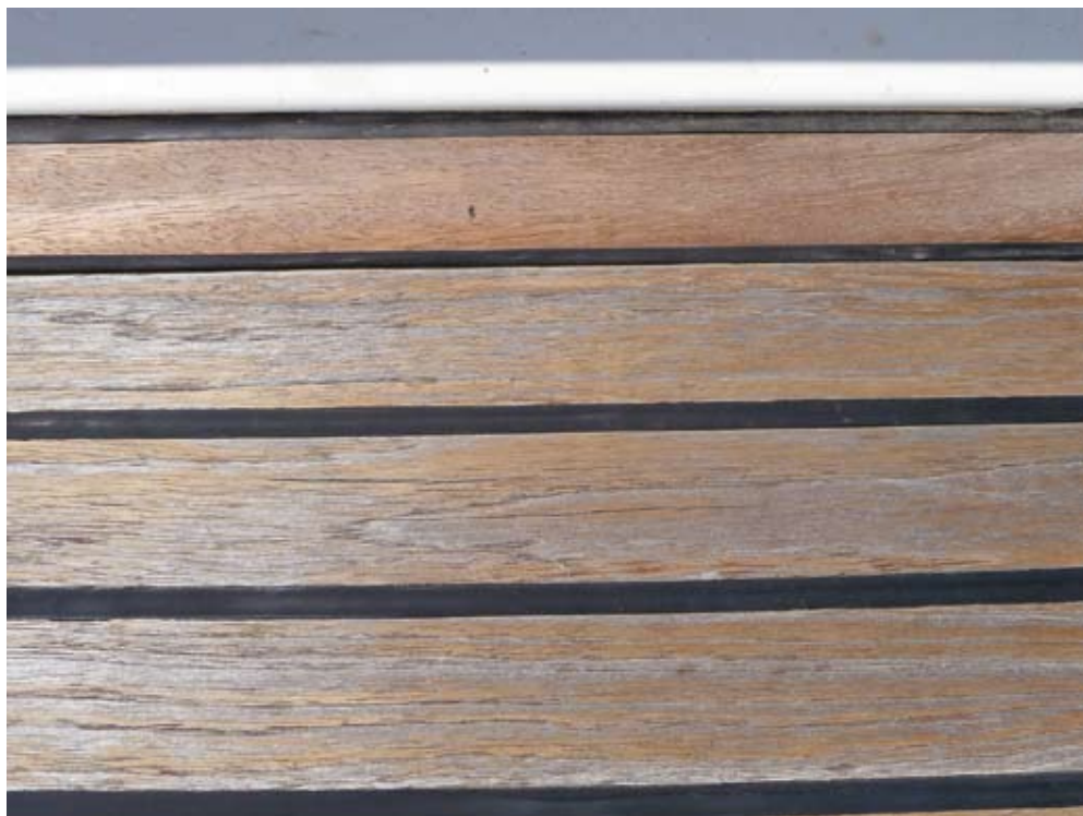
Apenas unas semanas después de instalado, el listón de madera nueva (en lo alto) va cogiendo el clásico tono gris de la madera tropical a la intemperie, mimetizándose con el resto del recubrimiento
