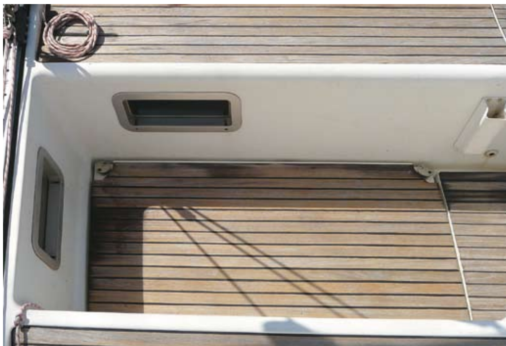
Renovar las juntas rejuvenece el aspecto de los recubrimientos de madera sin tener recurrir a un severo lijado que merme sustancialmente su grosor
